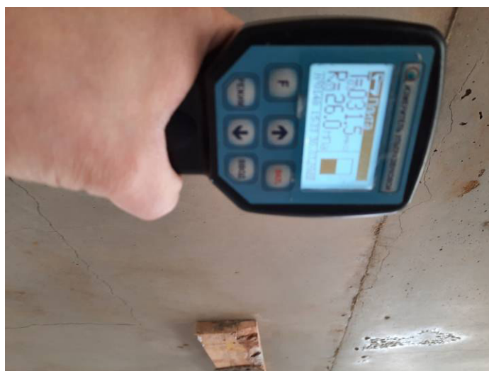
Фото № 116 Плотность бетона плиты 26 мПа.
