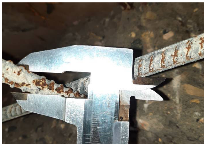
Фото № 78 Толщина арматуры 10 мм.
