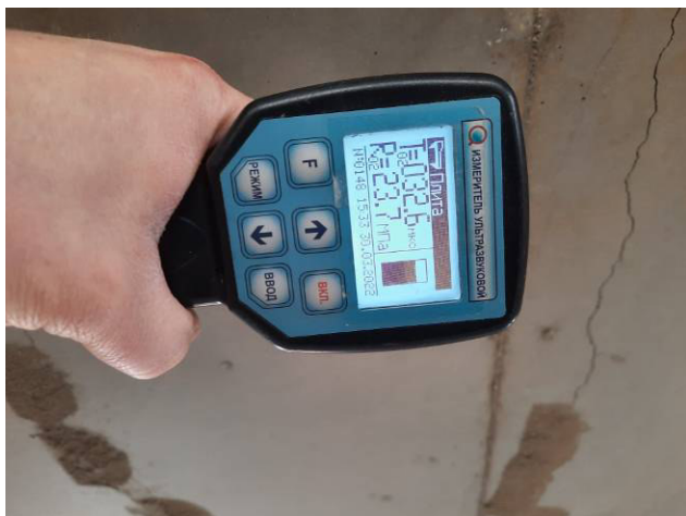
Фото №№ 106, 107 Плотность бетона плиты перекрытия 23,7 и 23,1 МПа.
