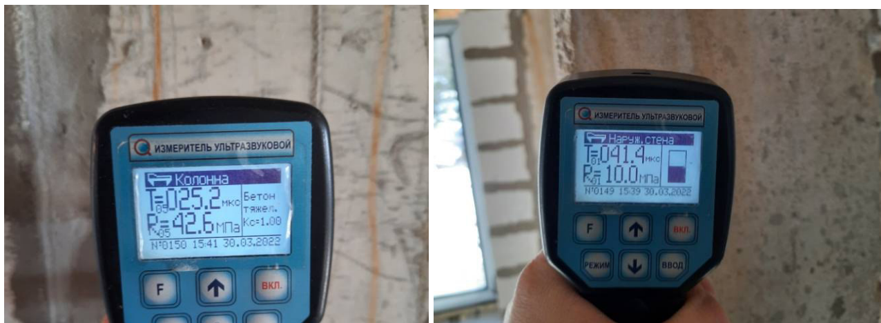
Фото №№ 114, 115 Плотность бетона 42,6 мПа и 10,0 мПа.
