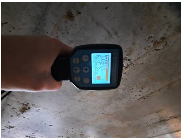
Фото №№ 112, 113 Плотность бетона плиты перекрытия 26,2 и 45,3 мПа.
