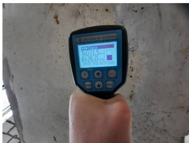
Фото №№ 110, 111 Плотность бетона плиты перекрытия 26,0 и 30,0 мПа.
