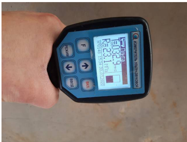
Фото №№ 106, 107 Плотность бетона плиты перекрытия 23,7 и 23,1 МПа.
