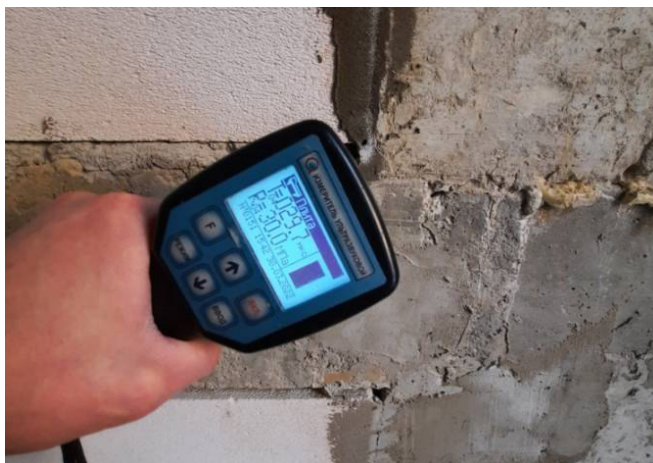
Фото №№ 110, 111 Плотность бетона плиты перекрытия 26,0 и 30,0 мПа.
