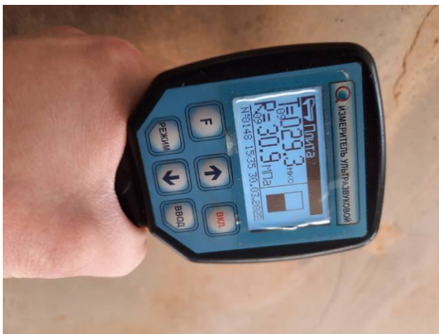
Фото №№ 108, 109 Плотность бетона плиты перекрытия 21,8 и 30,9 мПа.
