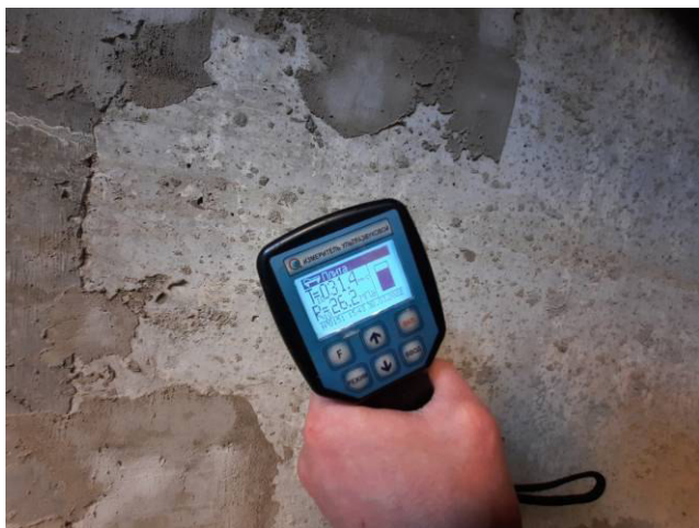
Фото №№ 112, 113 Плотность бетона плиты перекрытия 26,2 и 45,3 мПа.
