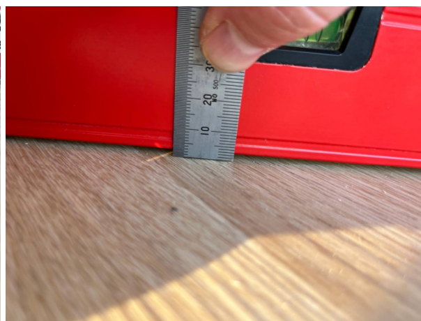
Фото №№ 90, 91 Отклонения от плоскости 4 и 3 мм.
