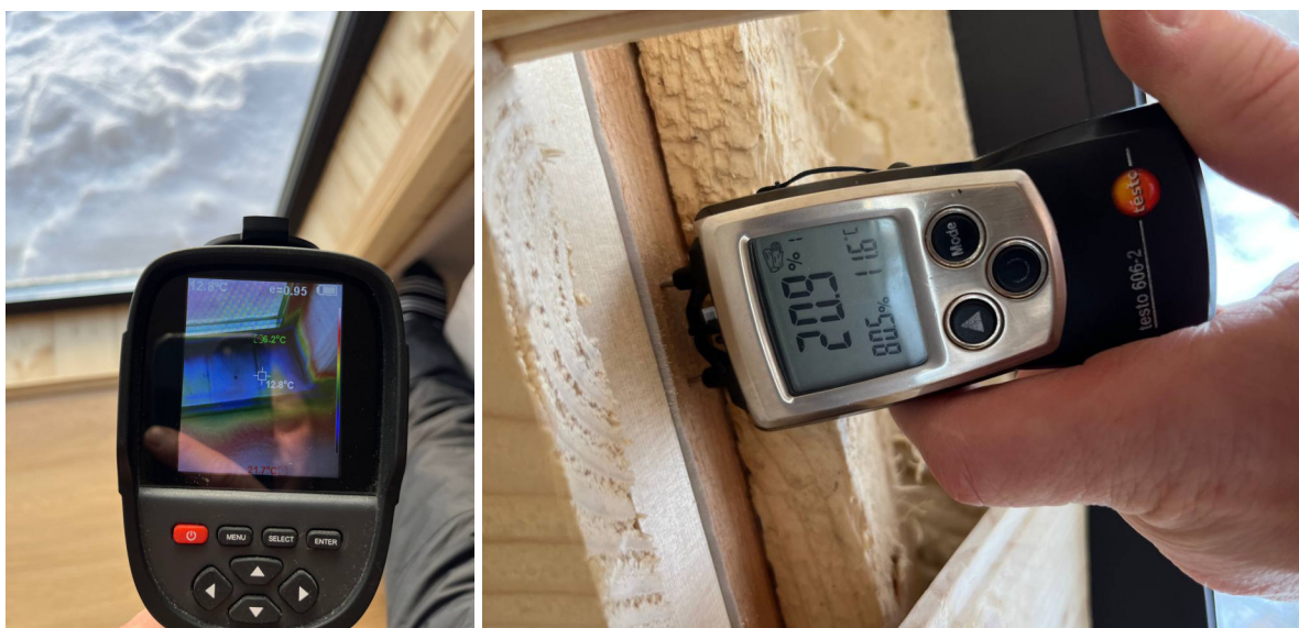
Фото №№ 55, 56 Монтажные швы промерзают. Зоны пониженной температуры (мостики холода). Повышенная влажность каркаса оконного проема.
