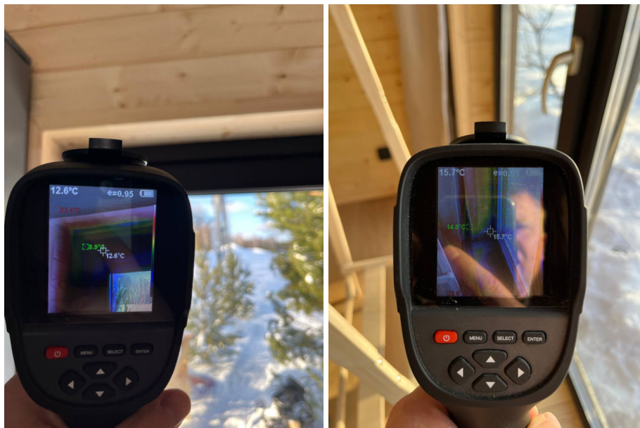
Фото №№ 53, 54 Монтажные швы промерзают. Зоны пониженной температуры (мостики холода).
