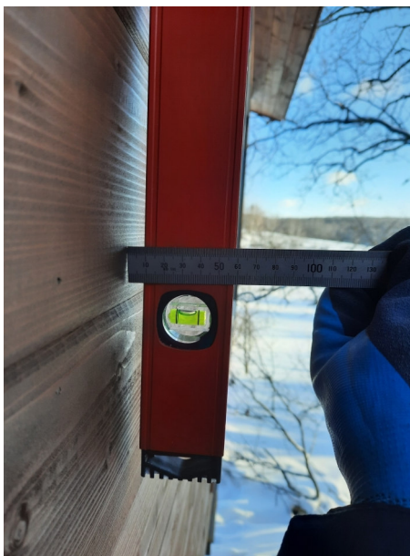
Фото № 66 Отклонение от вертикали 9 мм.
