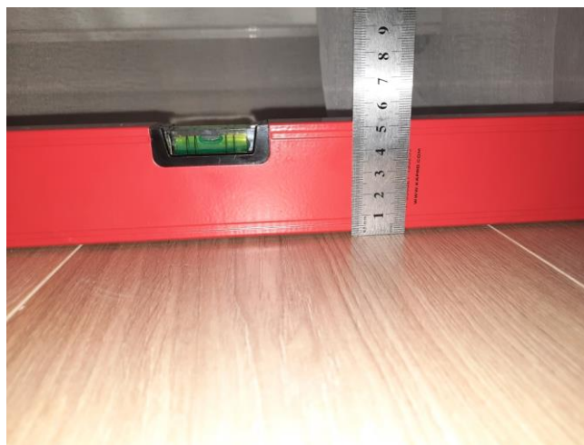
Фото №№ 43, 44 Отклонения поверхности напольного покрытия
