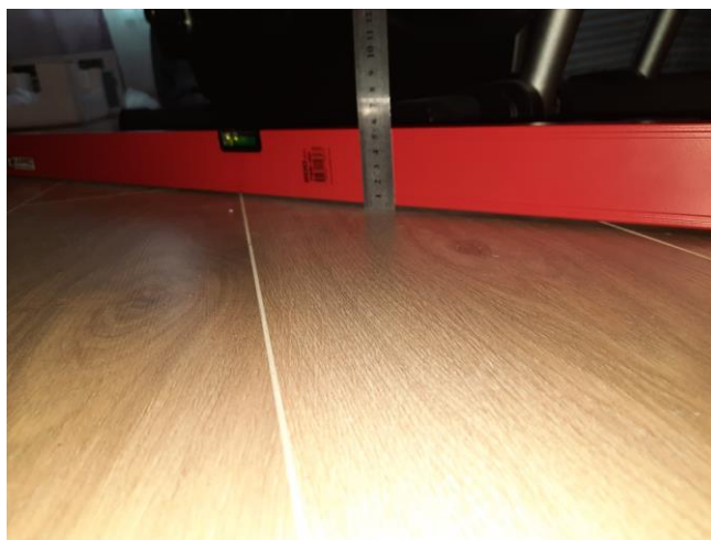
Фото №№ 43, 44 Отклонения поверхности напольного покрытия
