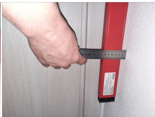
Фото №№ 16, 17 Неровности плавного очертания стен
