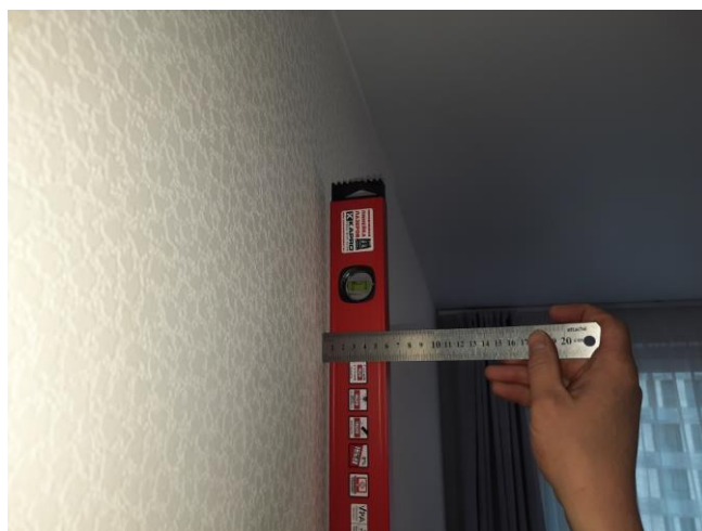
Фото №№ 18, 19 Отклонения плоскости стены от вертикали
