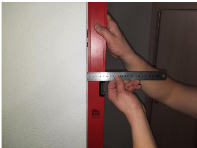
Фото №№ 10, 11 Неровность плавного очертания стены.
