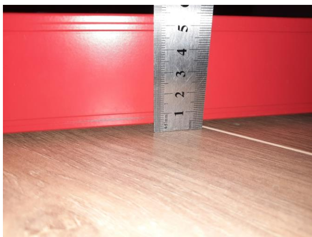
Фото №№ 45, 46 Отклонения поверхности напольного покрытия
