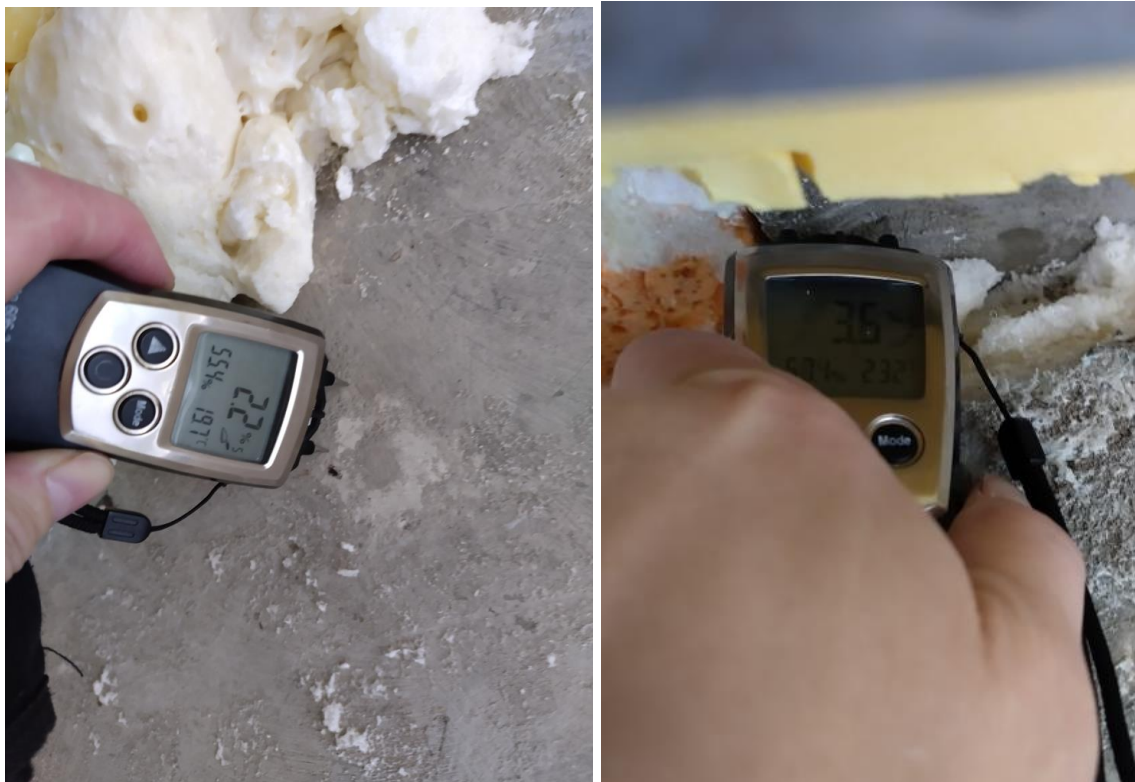
Фото №№ 10, 11 Замеры влажности стены над окном и верхней плиты перекрытия
