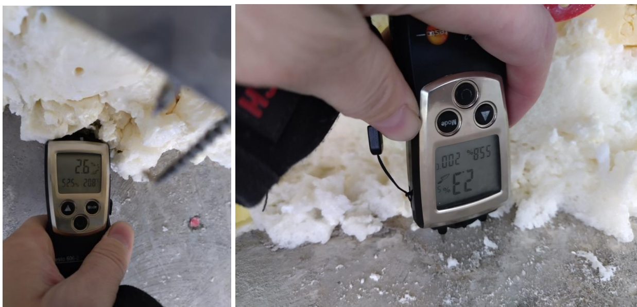
Фото №№ 12, 13 Замеры влажности стены над окном
