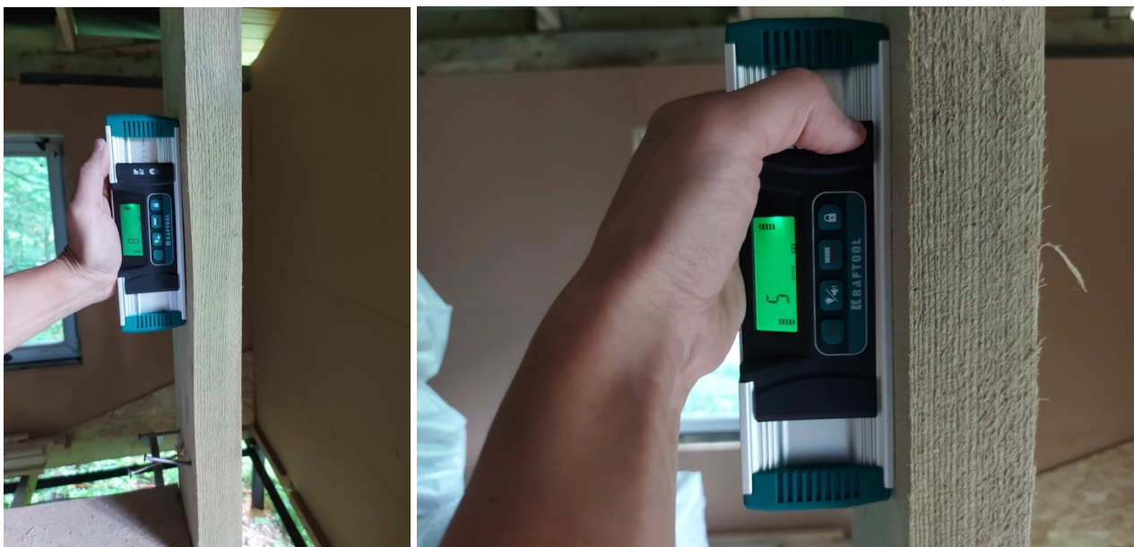
Фото №№ 93, 94 Отклонения стоек каркаса от вертикали 8 и 5 мм, на 1 м.
