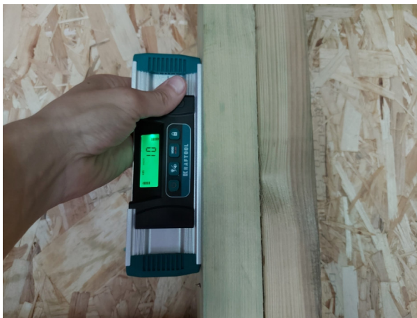
Фото №№ 89, 90 Отклонения стоек каркаса от вертикали 10 мм, на 1 м.
