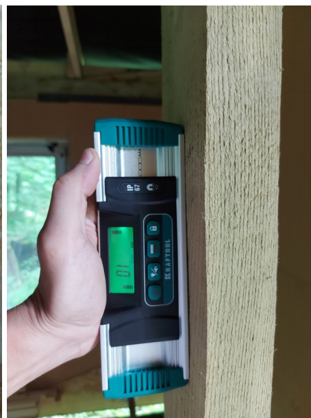
Фото №№ 91, 92 Отклонения стоек каркаса от вертикали 13 и 10 мм, на 1 м.
