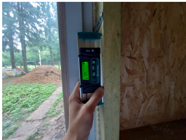
Фото №№ 89, 90 Отклонения стоек каркаса от вертикали 10 мм, на 1 м.
