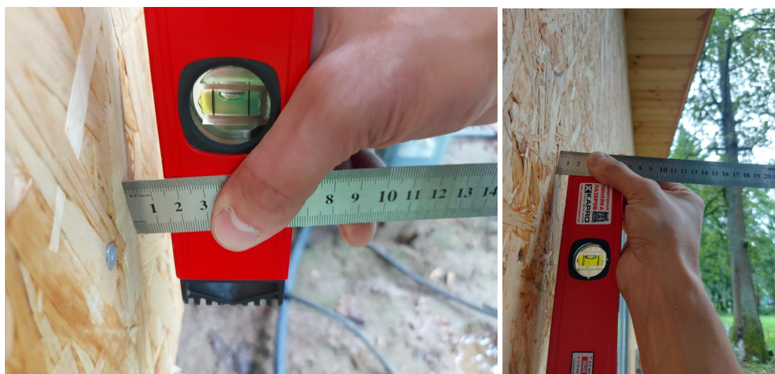
Фото №№ 131, 132 Отклонения от вертикали 15 и 12 мм.
