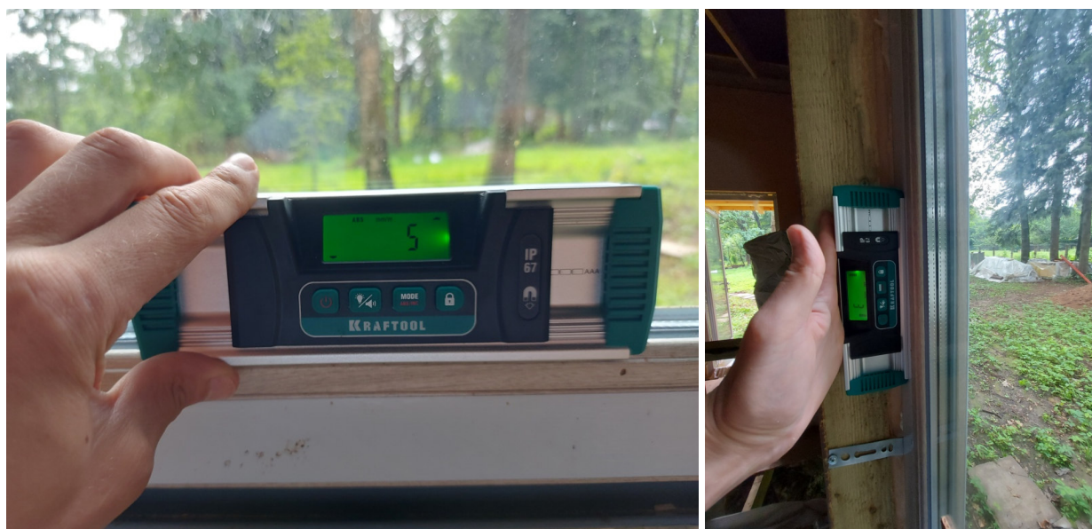
Фото №№ 112, 113 Отклонение оконного блока от горизонтали 5 мм на 1 м. Отклонение от вертикали 3 мм на 1 м.
