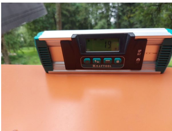
Фото №№ 176, 177 Отклонение карниза от горизонтали 19 мм, на 1 м.
