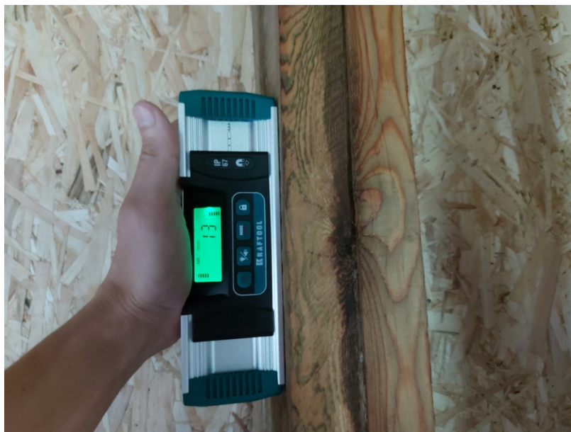
Фото №№ 91, 92 Отклонения стоек каркаса от вертикали 13 и 10 мм, на 1 м.
